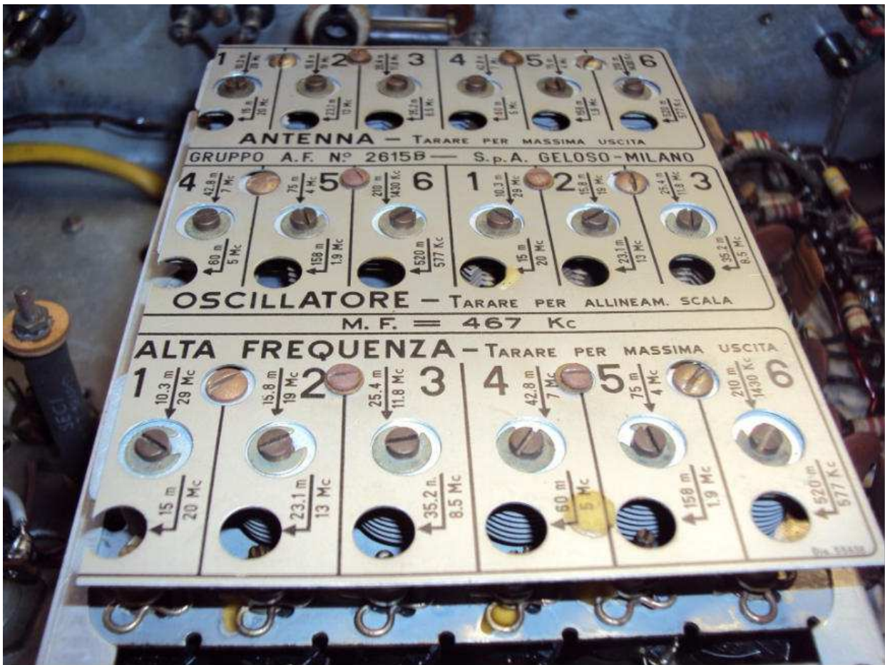
il gruppo della seconda serie si nota dopo la sigla N° 2615 la B aggiunta sulla serigrafia a mano con matita di china
